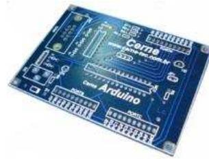
Figura C.2: uma placa de circuito impresso para arduino
