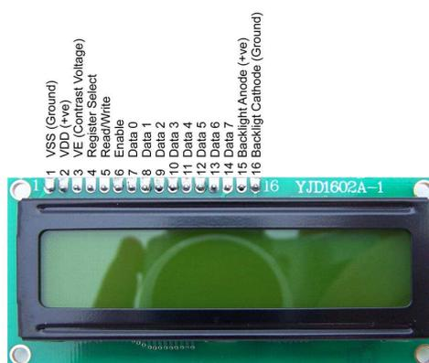
Figura A.16: Descrição de cada pino de um LCD 16x2 5V
