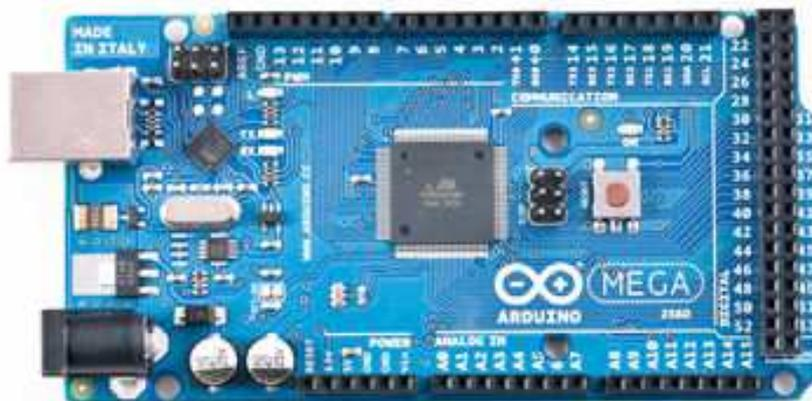
Figura 1: Arduino Mega 2560
