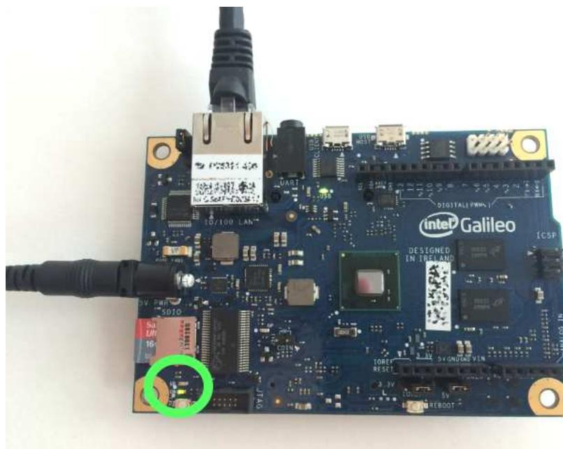
Figura 4.8: LED indicando o funcionamento do sistema operacional.
