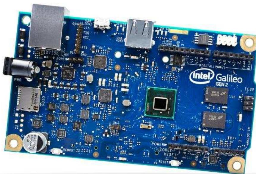
Figura 1.3: Placa Intel® Galileo geração 2.
