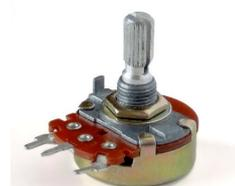
Figura 22: Potenciômetro 10K $\Omega$
